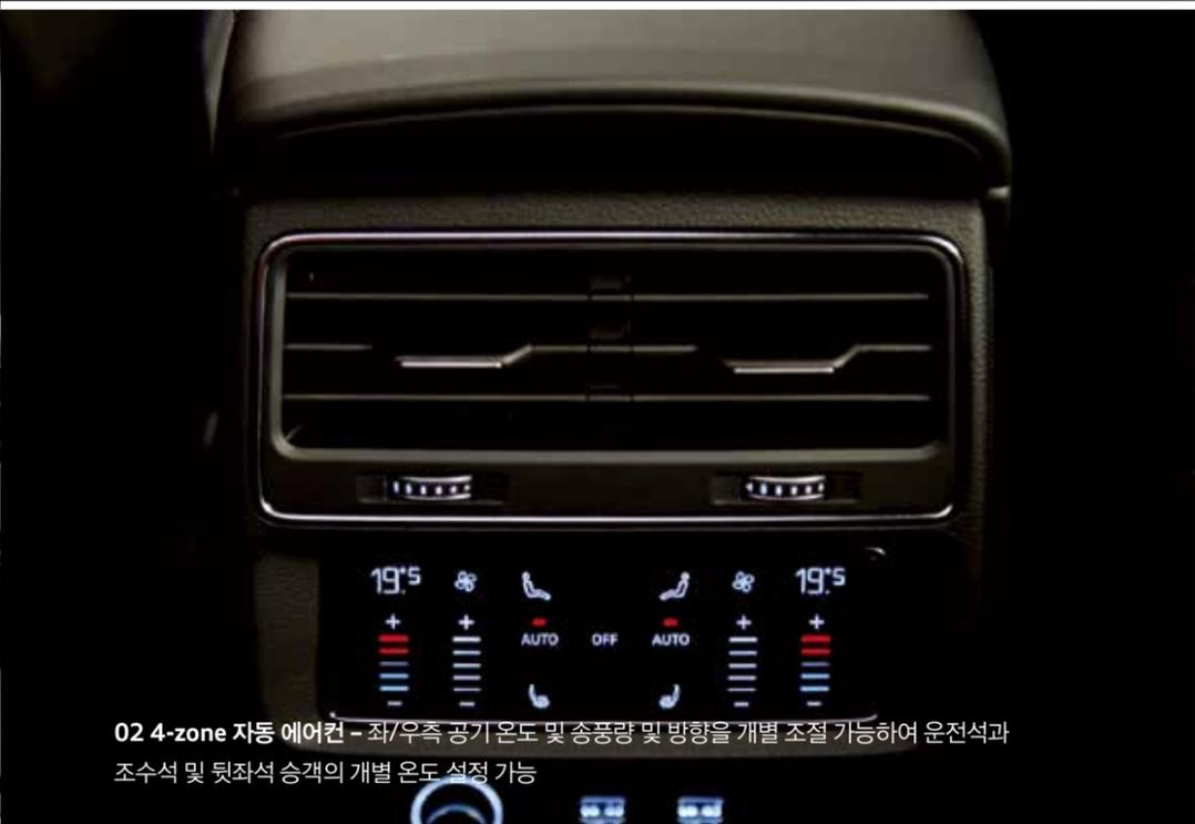
02 4-zone 자동 에어컨 - 좌/우측 공기 온도 및 송풍량 및 방향을 개별 조절 가능하여 운전석과 조수석 및 뒷좌석 승객의 개별 온도 설정 가능
