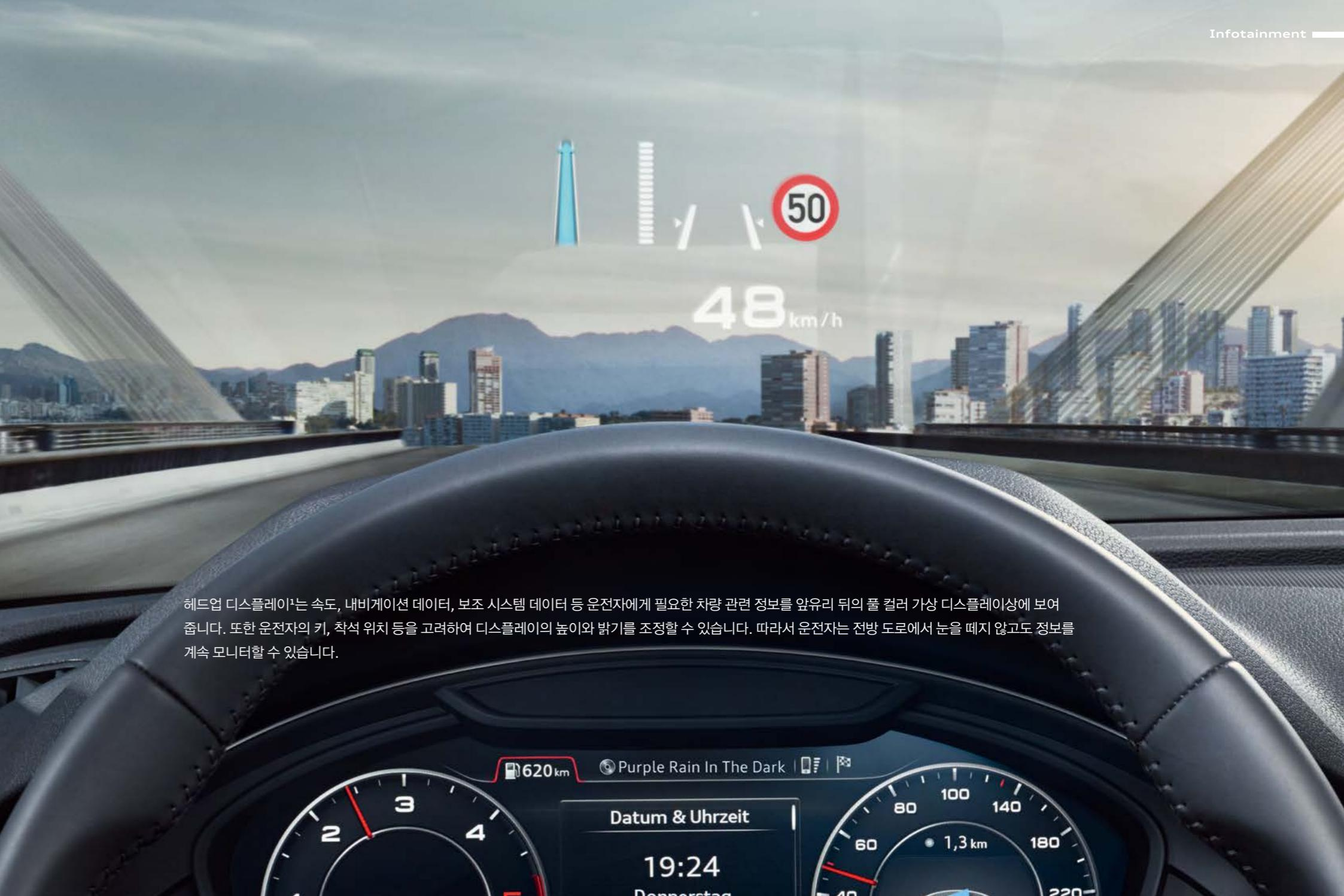
헤드업 디스플레이<sup>1</sup>는 속도, 내비게이션 데이터, 보조 시스템 데이터 등 운전자에게 필요한 차량 관련 정보를 앞유리 뒤의 풀 컬러 가상 디스플레이상에 보여 줍니다. 또한 운전자의 키, 착석 위치 등을 고려하여 디스플레이의 높이와 밝기를 조정할 수 있습니다. 따라서 운전자는 전방 도로에서 눈을 떼지 않고도 정보를 계속 모니터할 수 있습니다.
